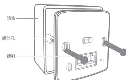
4 根据图示方向固定壳盖，完成安装。
